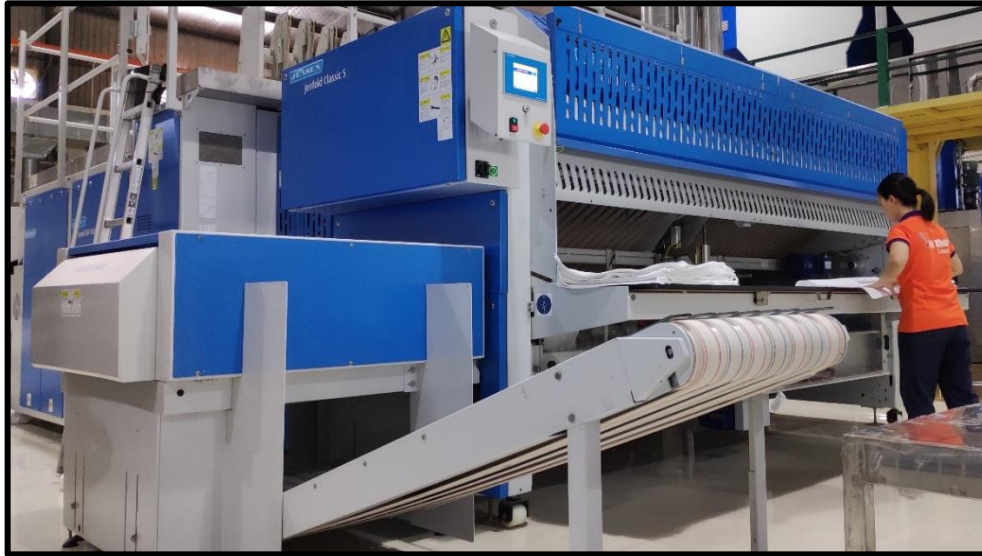
Hình 07: Hệ ủi cuốn 2 trục Jenroll EXP800 – Gấp xếp Classic S- Băng tải Jenstack Max
