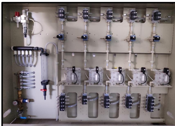
Hình 2b: Hệ thống bơm định lượng hóa chất dành cho máy giặt liên hoàn
