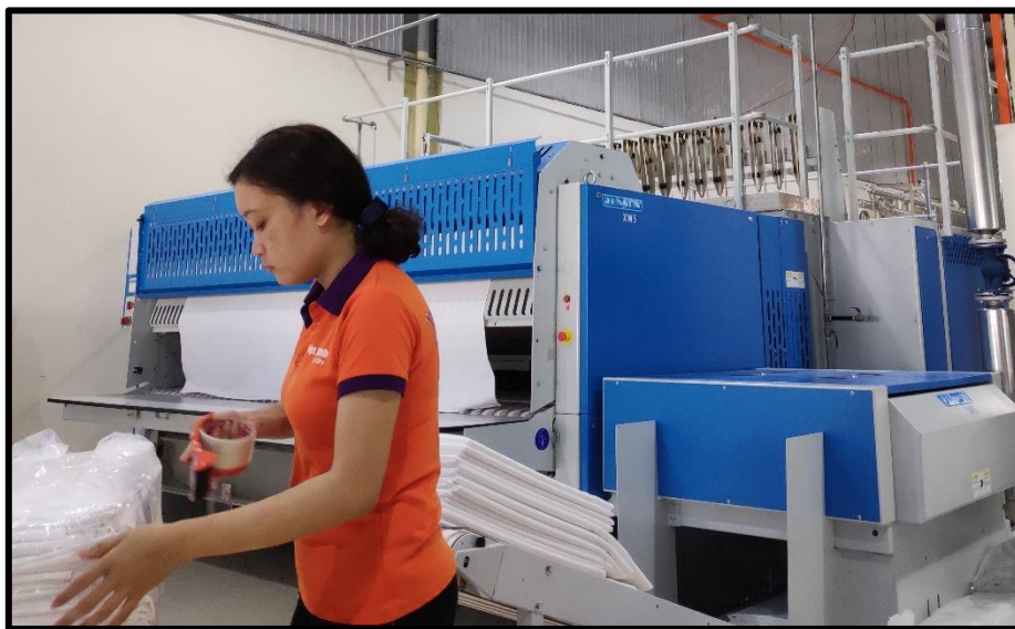
Hình 08: Hệ ủi cuốn 3 trục Alpha I5 – Gấp xếp Alpha XW5- Băng tải Alpha SW5
